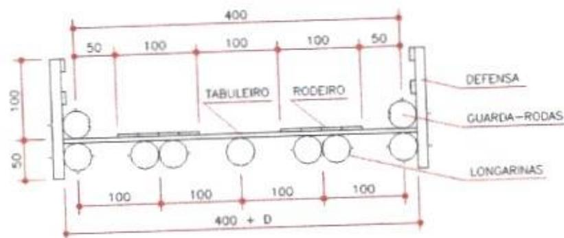
Figura 5 - Seção transversal da ponte em vigas roliças. Fonte: Calil Junior (2006 p. 80).
