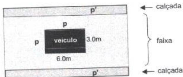
Figura 1 - Disposição em planta das cargas móveis
