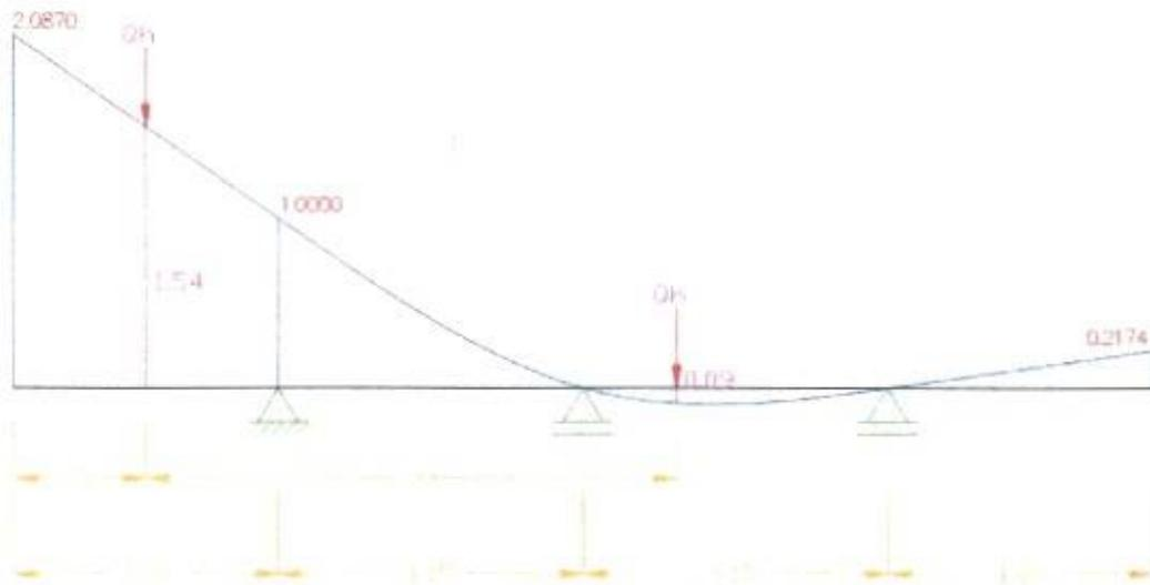
Figura 28 - Linha de influência das ações do veículo sobre o tabuleiro
