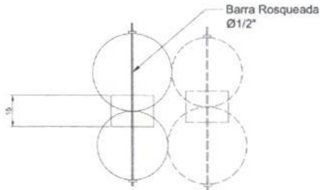
Figura 38 - Esquema de ligação dos anéis metálicos
