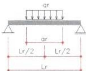
Figura 13 - Posicionamento crítico de uma roda sobre o tabuleiro
