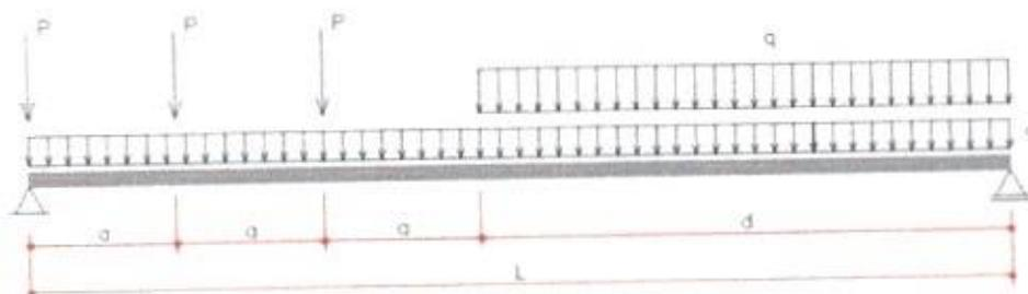
Figura 11 - Posicionamento do veículo-tipo para reação de apoio
