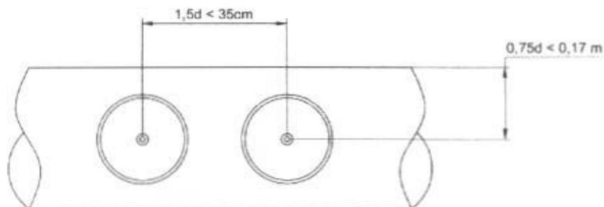
Figura 39 - Verificação dos critérios de distanciamento dos anéis metálicos
