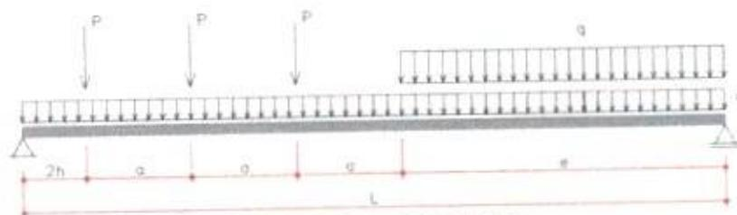
Figura 12 - Posicionamento do veículo-tipo para cortante
