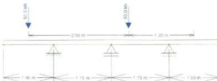
Figura 24 - Carregamento do veículo sobre o tabuleiro
