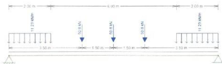
Figura 32 - Posicionamento do trem tipo para cálculo do momento fletor máximo
