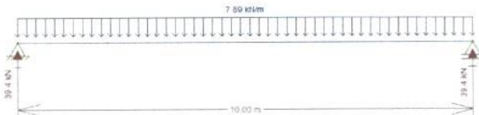
Figura 29 - Carregamento do peso próprio da longarina e reações de apoio. Fonte: Os Autores.
