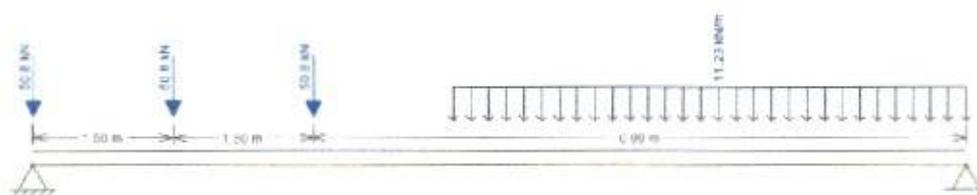
Figura 35 - Posicionamento do trem tipo para cálculo dos esforços cortantes
