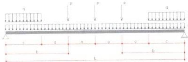
Figura 10 - Posicionamento do veículo-tipo para momento fletor e deslocamento vertical máximo
