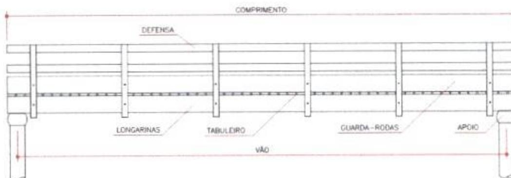
Figura 7 - Vista lateral da ponte em vigas
