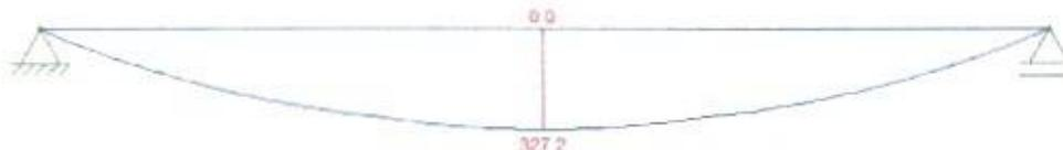
Figura 33 - Momento fletor máximo devido às cargas acidentais sobre a longarina
