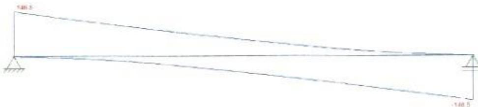
Figura 36 - Esforço cortante máximo devido às cargas acidentais sobre a longarina
