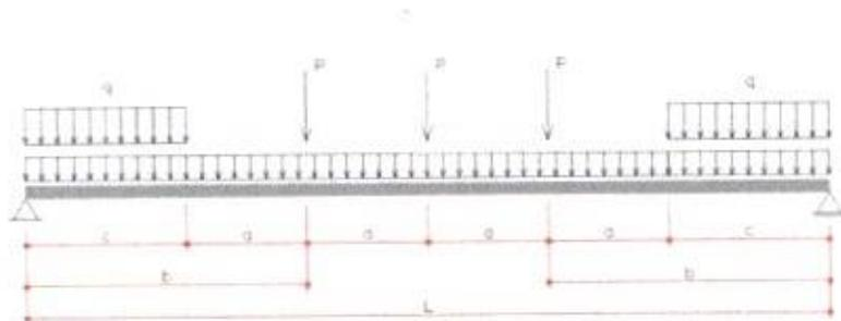
Figura 10 - Posicionamento do veículo-tipo para momento fletor e deslocamento vertical máximo
