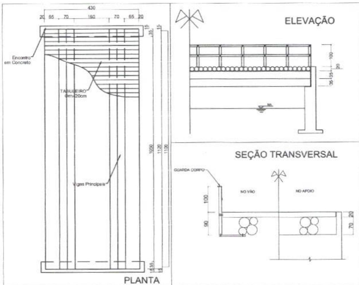
Figura 20 - Projeto de ponte de madeira sobre o Rio Itaqui - São José dos Pinhais, Paraná Fonte: Adaptado de AAD(1998).
