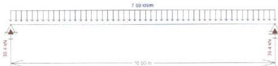
Figura 29 - Carregamento do peso próprio da longarina e reações de apoio
