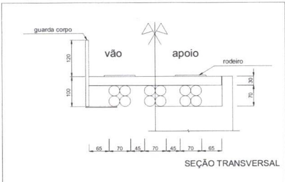
Figura 23 - Projeto da ponte de madeira - seção transversal
