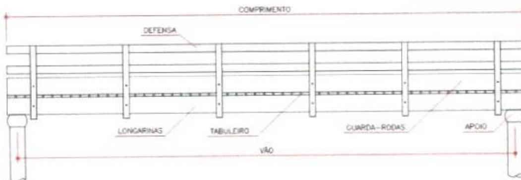
Figura 7 - Vista lateral da ponte em vigas roliças
