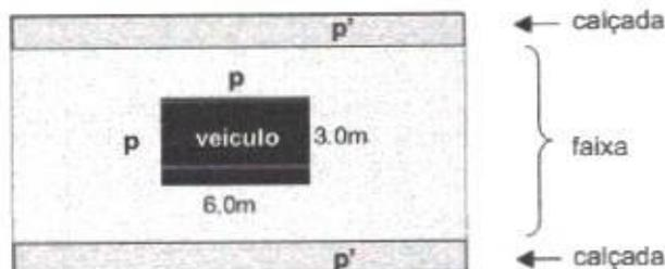
Figura 1 - Disposição em planta das cargas móveis
